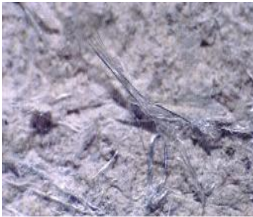
Superficie esterna di Lastra esposta per oltre 10 anni agli agenti atmosferici. Si notano ciuffi di amianto blu (crocidolite) (160X)
